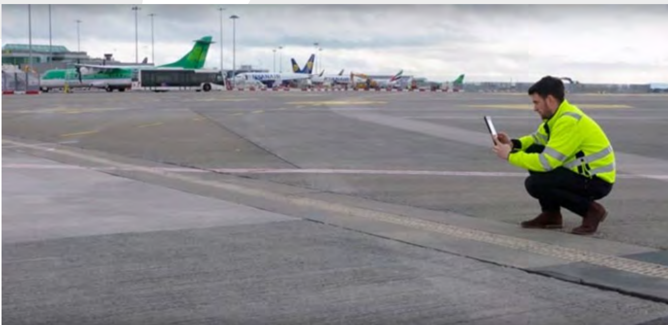
Співробітник аеропорту Дублін використовує мобільний додаток Collector for ArcGIS на своєму пристрої для збору даних про стан покриття доріжок льотного поля.
